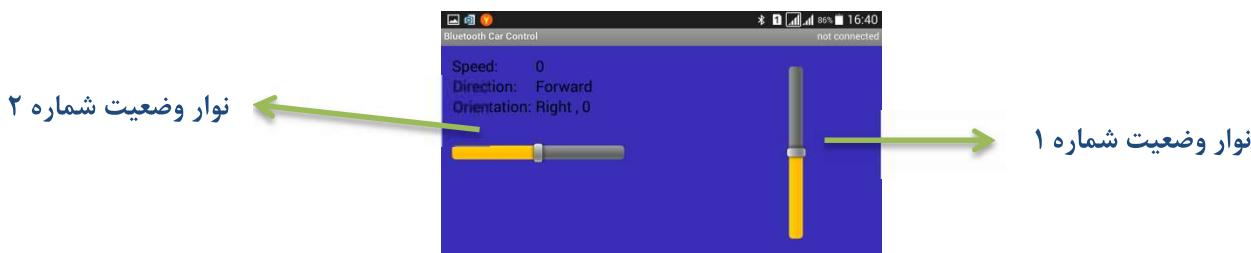
در حالتی که گوشی به درایور بلوتوثی متصل نشده است، نوار وضعیت قابل حرکت نمی باشد (جهت متصل شدن به درایور به مرحله شماره ۴ مراجعه شود). در حالت عادی دو نوار وضعیت در وسط قرار گرفته اند. اگر نوار وضعیت شماره ۱ به سمت بالا حرکت داده شود موتور به سمت جلو و با افزایش جابجایی سرعت آن افزایش یافته و اگر به سمت پایین حرکت داده شود موتور به سمت عقب و با افزایش جابجایی آن نسبت به مرکز سرعت آن به سمت عقب افزایش می یابد.
